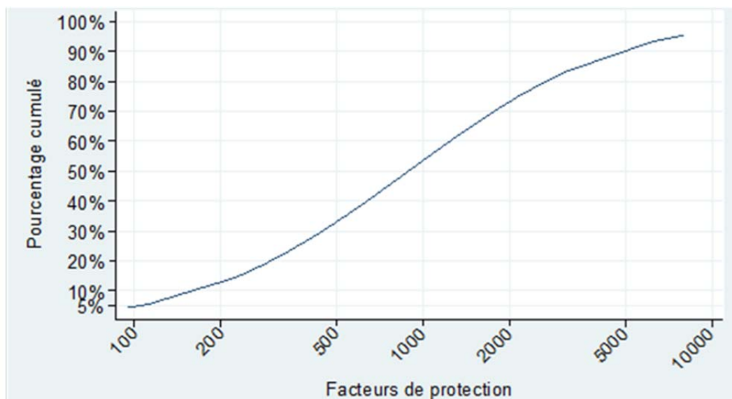
Figure 5. Distribution des facteurs de protection calculés pour les 3 chantiers de désamiantage étudiés en niveau 2 et pour les opérateurs de désamiantage seuls
